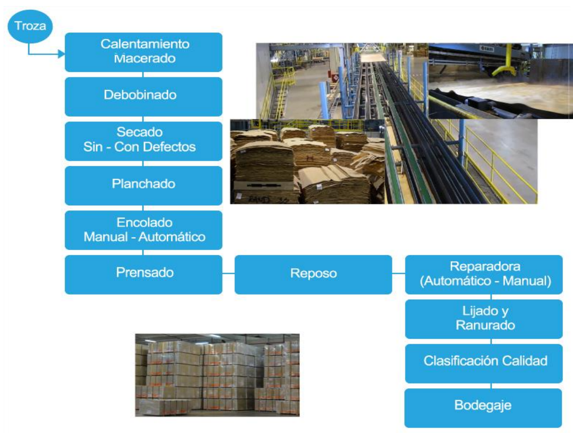
Figura N° 9: Proceso tipo de fabricación de tableros contrachapados debobinados
